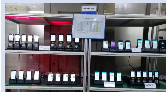
ИСПЫТАНИЕ НА СТАРЕНИЕ
