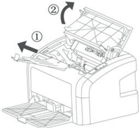
4. Вставьте картридж с тонером в принтер. Убедитесь, что картридж установлен на место (так, что его нельзя сдвинуть вниз или повернуть), а затем закройте верхнюю крышку.
