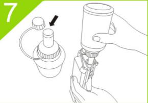
**RU** Откройте тубу с тонером и поместив её напротив отверстия для досыпки тонера заполните бункер для тонера
