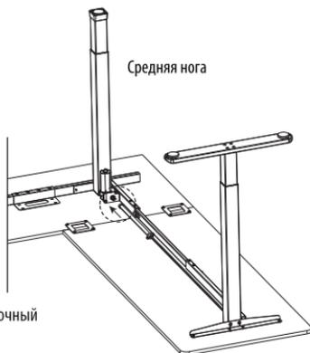
Убедитесь, что передаточный стержень правильно вставлен в отверстие в левой ноге. Плавно соедините другой конец стержня с концом приводного вала двигателя на средней ножке стола.
