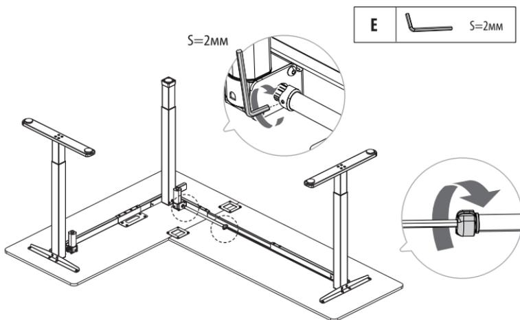
Закрепите шток трансмиссии на приводном валу двигателя, повернув установочный винт по часовой стрелке. Затем затяните накидную гайку, чтобы точно отрегулировать посадку штока трансмиссии.
