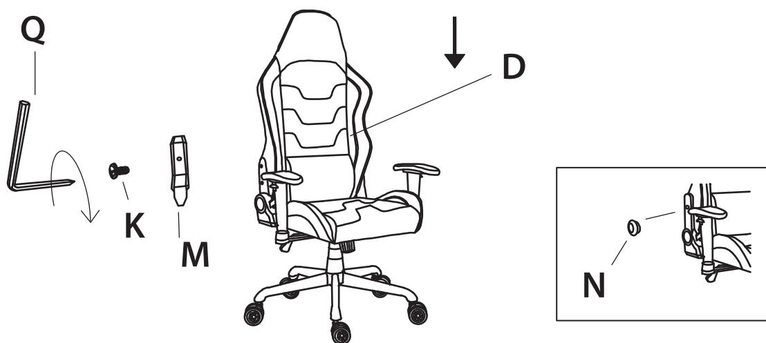
На этом шаге установите накладки М при помощи крепежа К и ключа Q.
