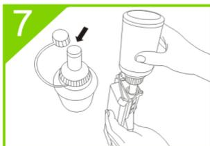
**RU** Откройте трубу с тонером и поместив её напротив отверстия для досыпки тонера заполните бункер для тонера
